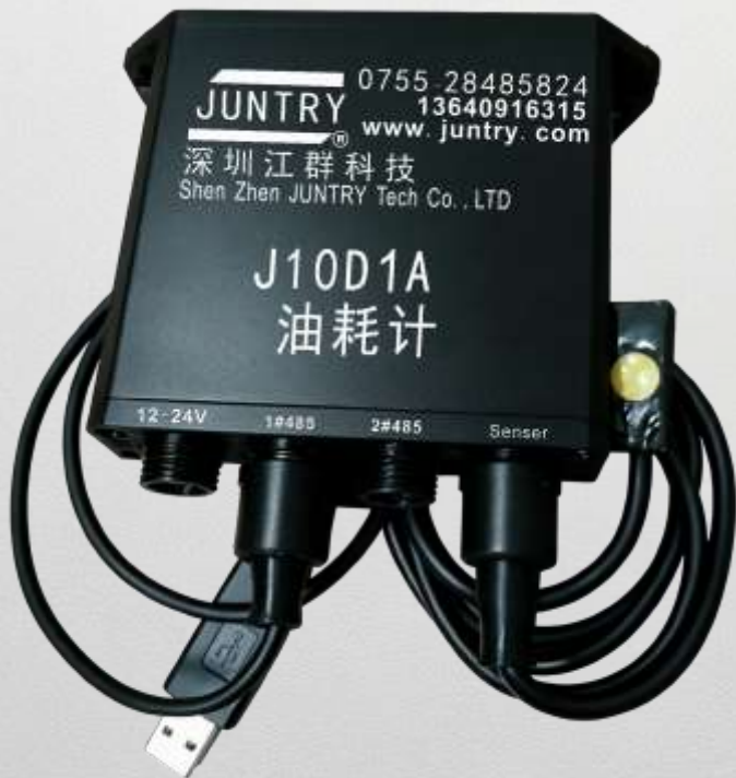
J10D1A 超声波油耗传感器 专为严苛工业环境设计的智能监测终端
