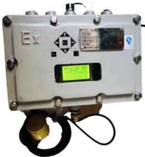
由江群科技有限公司研制、开发、生产的,歼十五(外贴)下贴隔爆式超声液位控制器(J15D31B)。超声波探头外贴安装于被测容器外壁的正下方,透过 18 毫米内的钢,铁,不锈钢,玻璃,朔料,玻璃钢材料的容器壁;连续、精确地测量罐内的液位,完全不接触罐内的液体和气体,实现了真正的隔离测量。因此具有其他液位计无法比拟的七大特点:
