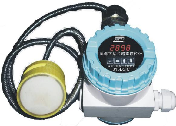
由江群科技有限公司研制、开发、生产的, 穿十五(外贴)下贴隔爆式超声液位计(J15D3IC)。超声波探头外贴安装于被测容器外壁的正下方, 透过 18 毫米内的钢, 铁, 不锈钢, 玻璃, 脂料, 玻璃钢材料的容器壁; 连续、精确地测量罐内的液位, 完全不接触罐内的液体和气体, 实现了真正的隔离测量。因此具有其他液位计无法比拟的七大特点:
